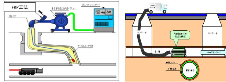
内面被覆工：道路を掘削しないで、古い管の耐久性を向上させる工法
