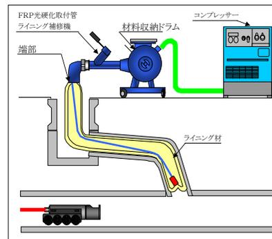
内面被覆工事にて補修した取付管
