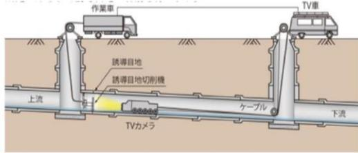
上流・下流のマンホールへ削孔機・TVカメラにて端部切断を行います。
